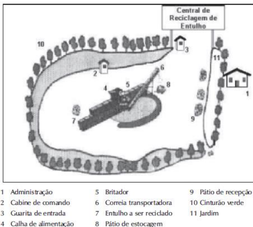
Figura 183 - Diagrama de usina de beneficiamento de RCC.
