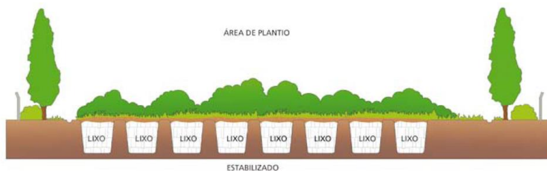
Figura 161 - Diagrama de encerramento de área de aterro de RSU (parte 2).
