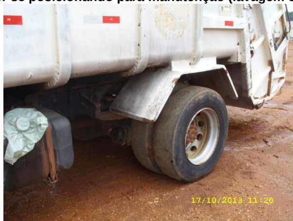
Figura 123 - Evidência do aspecto de desgaste de pneus de caminhão compactador de lixo
