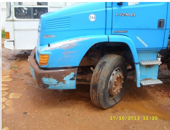
Figura 28 - Evidência do Caminhão compactador de lixo reserva com pneu vazio no pátio (inapto)
