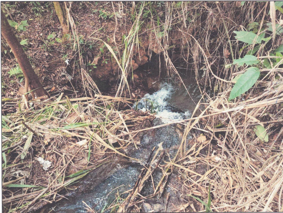
Figura 3. Fotografia evidenciando canais preferenciais de percolação da água do aterro, Patrocínio – MG.
