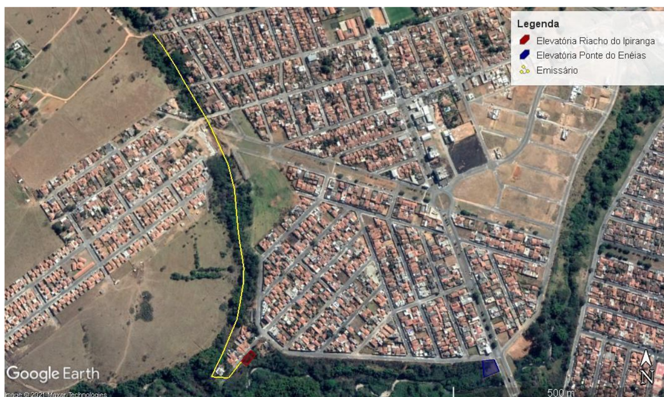
Figura 1: linha em destaque: caminhamento do emissário de esgoto – margem esquerda do curso d'água, afluente do Córrego Rangel – passagem toda pela APP
