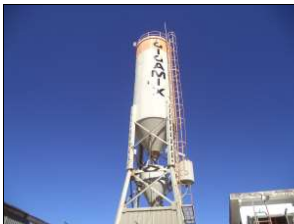
Figura 11: Em detalhe, silo com cimento
