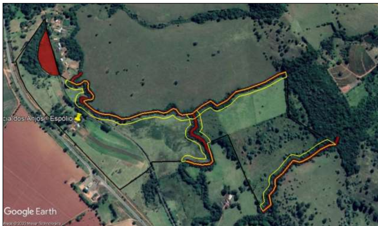
Figura 05: em vermelho a faixa mínima de APP que o imóvel precisa ter (08 metros) e em amarelo a faixa de 30 metros, que o imóvel deveria ter se não fosse enquadrado como uso consolidado de acordo com a Lei Estadual nº 20.922 de 2013.
