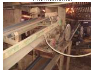
Fotos 19, 20 e 21: entrada de matéria-prima, observar teto mais baixo para reduzir ventilação
