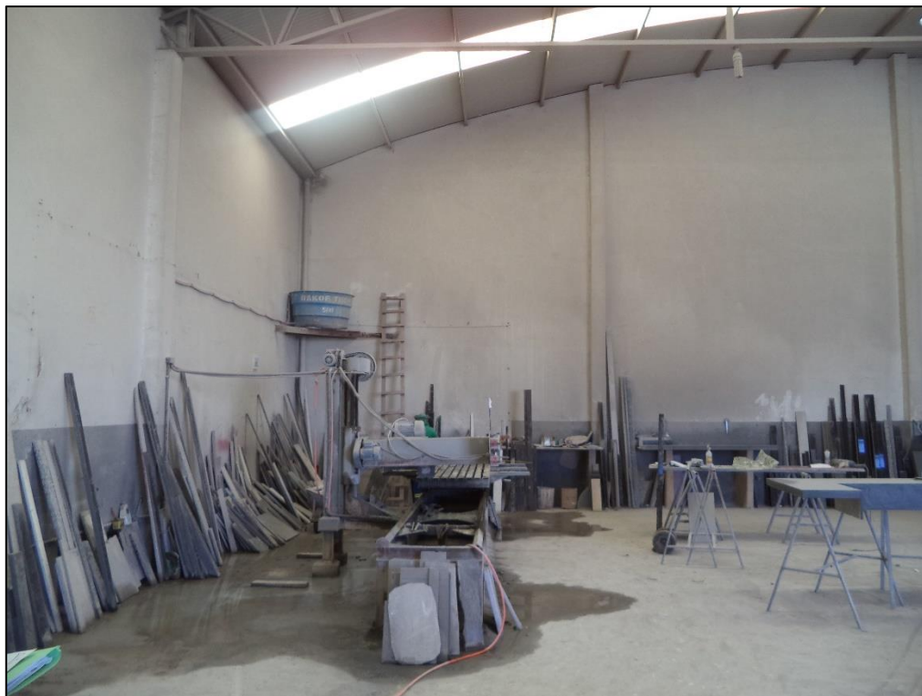
Foto 04: Vista da área molhada no entorno do equipamento de serra, evidenciando a utilização de água no processo.
