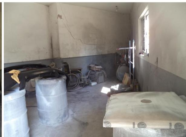
Figuras 03 e 04: Cômado de pintura das peças dos veículos. Observar que o mesmo não apresenta exaustor(es) de ar com filtro e possui abertura de porta e janela
