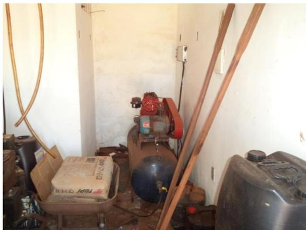
**Figura 14:** Compressor utilizado na lavagem dos veículos
