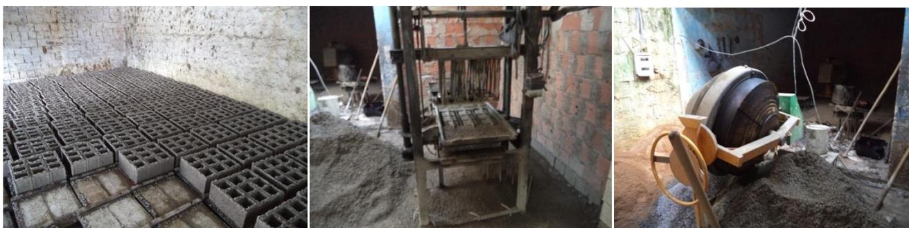
**Figuras 4, 5 e 6:** Galpão semi-fechado utilizado para produção em si. Vê-se na figura 4 blocos recém-fabricados, na figura 5: a máquina extrusora e na figura 6: a betoneira, onde se produz a mistura para abastecer a extrusora.
