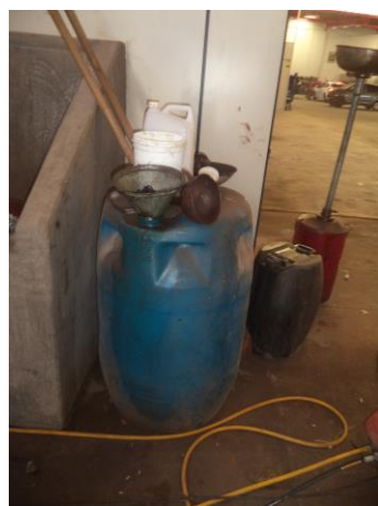
Figura 08: Recipiente de armazenagem de efluentes oleosos
