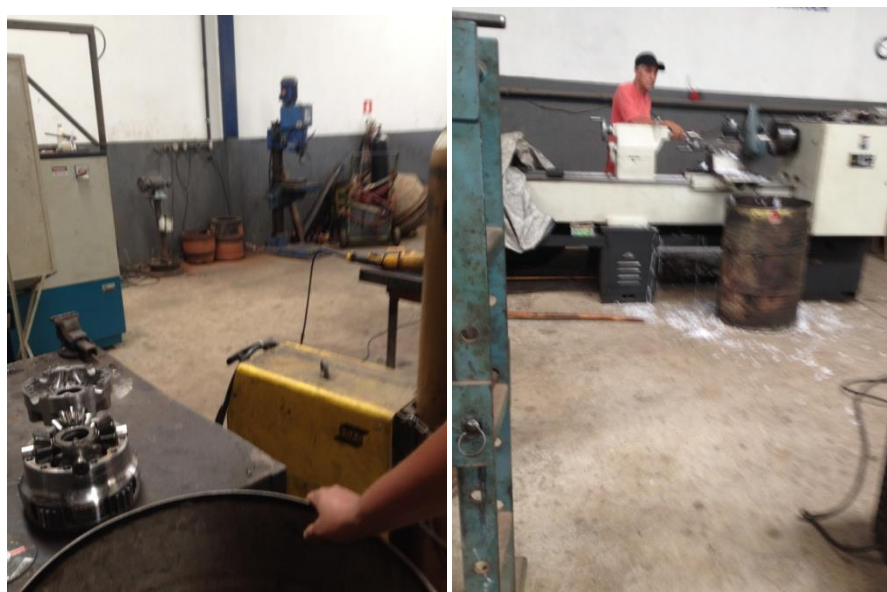
Fotos 06 e 07: Equipamento de Solda MIG e torno trabalhando o Technyl®
