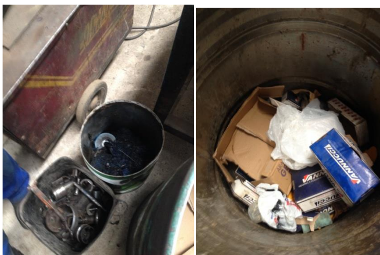
Fotos 04 e 05: Tambores usados na separação dos materiais contaminados com óleo dos limpos
