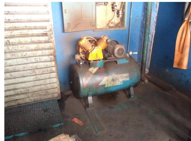
**Figura 08:** Compressor usado no lavador de peças
