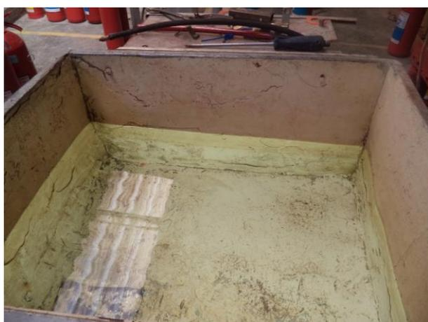
**Figura 19:** Tanque com água para teste de estanqueidade
