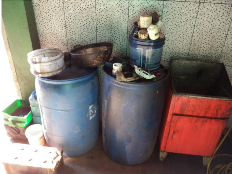
**Foto 11: óleo usado armazenado em bombonas plásticas**
