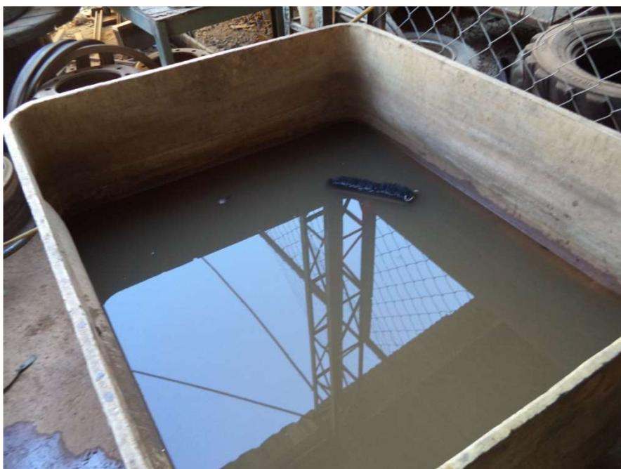
**Figura 6: Caixa d'água utilizada para verificar furos em câmeras de ar**
