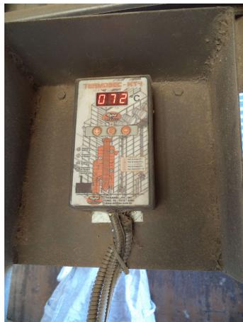
**Figura 32:** Termostato para controle da temperatura dentro do secador
