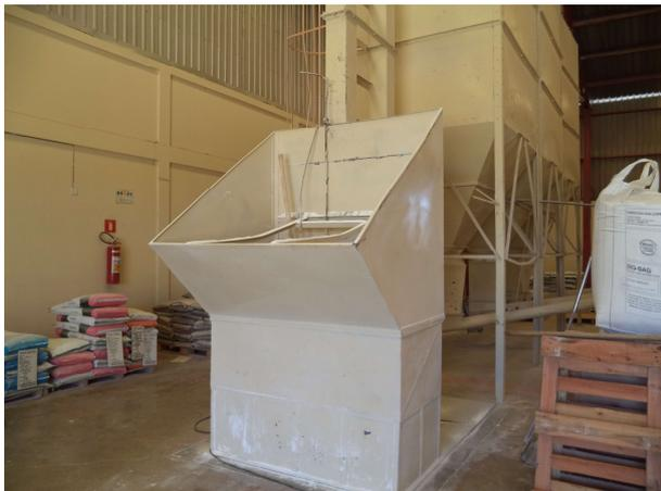
**Figura 01:** Silos dosadores de matérias-primas
