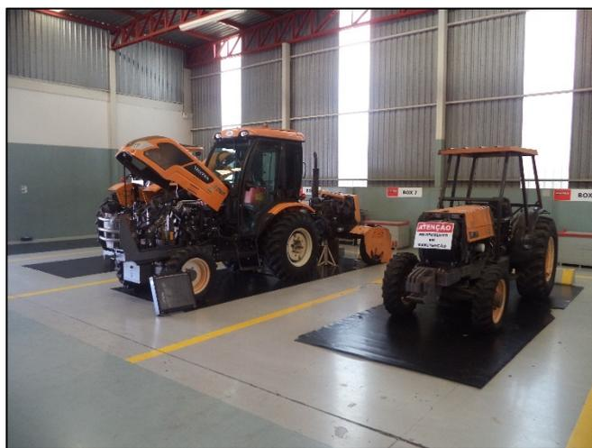
Foto 02: Oficina Mecânica utilizando sistema de "Borrachão"
