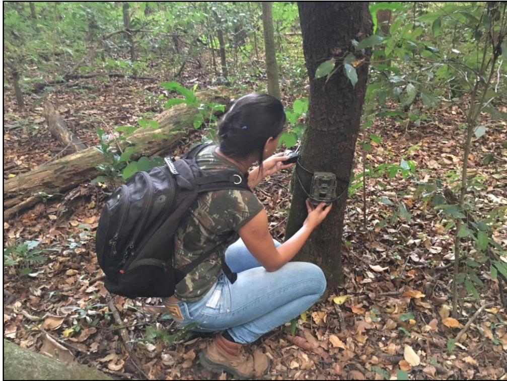
Figura 54: Detalhe da instalação da armadilha, altura equivalente a 30cm e fixação correta a árvore.
